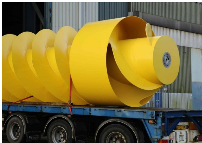
LANDY Archimedes skruepumpe forlader produktionen i Sneek, Holland, på vej mod Miami River Dike Flood Pump Station (2016)
